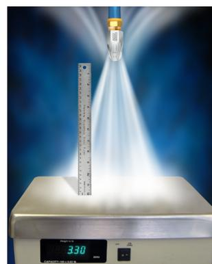
Die von uns angegebene Blaskraft (in Gramm) bei allen Düsen wurde vom Hersteller mittels einer Waage gemessen, und zwar in einem Abstand von 30 cm zur Düse weg, bei 5,5 bar Eingangsdruck (siehe Bild).
