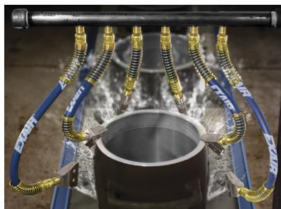
Flexible, abgesteifte Schläuche (Flexible Stay Set Hoses™) sind ideal, wenn häufiges Nachposi-tionieren von Abblasdüsen erforderlich ist.
