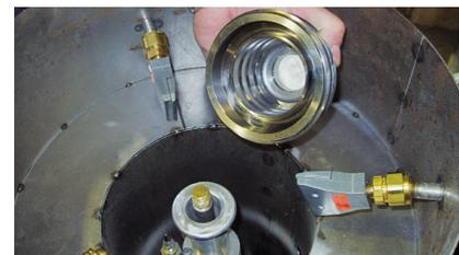
Kraft und Durchfluss können einfach erhöht oder verringert werden, in dem verschiedene Abstandsfolien (Shims) installiert werden.
