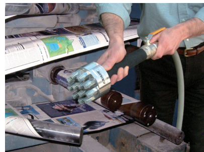
Die Sicherheitsblaskanone, Modell I213-12, bläst Papierstaub aus einer Papierrollenpresse und kommt mit ihrem Luftstrom tief in die schwer zugänglichen Bereiche hinein.
