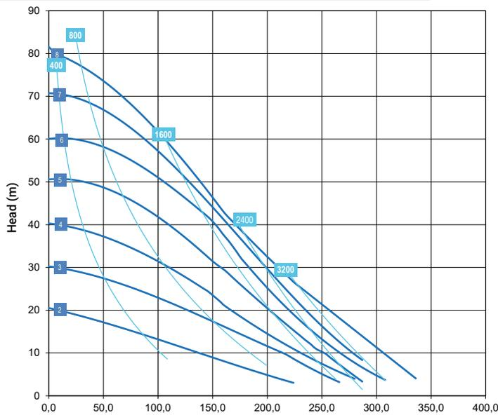
\* Die Kurven und Leistungen beziehen sich auf Pumpen mit Tauchansaugung und freiem Druckschluss, mit Wasser bei einer Temperatur von 20 °C und variieren je nach Materialzusammensetzung.
