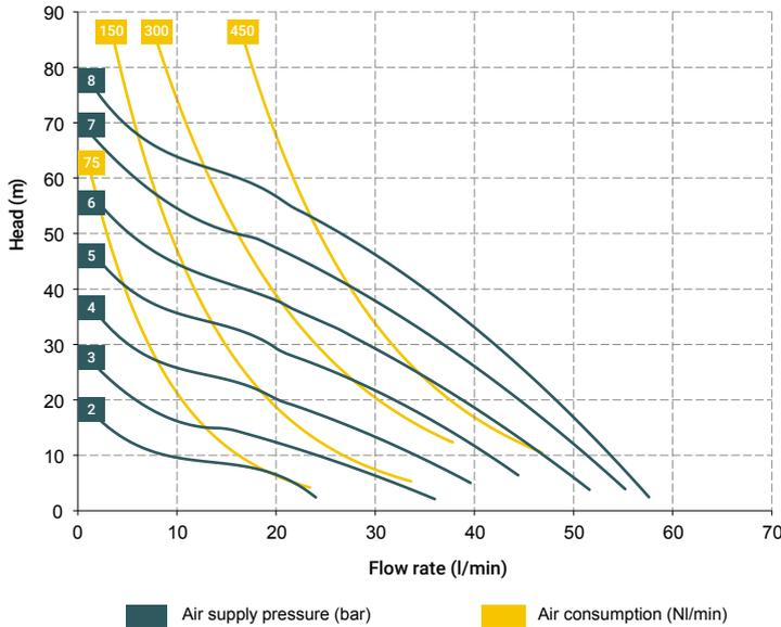
\*Die Kurven und Leistungen beziehen sich auf Pumpen mit Tauchansaugung und freiem Druckanschluss, mit Wasser bei einer Temperatur von 20 °C und variieren je nach Materialzusammensetzung.
