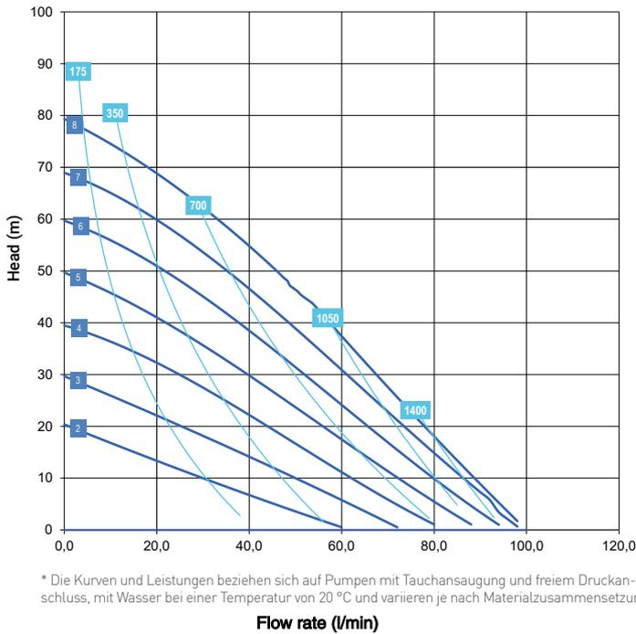
\* Die Kurven und Leistungen beziehen sich auf Pumpen mit Tauchansaugung und freiem Druckanschluss, mit Wasser bei einer Temperatur von 20 °C und variieren je nach Materialzusammensetzung.
