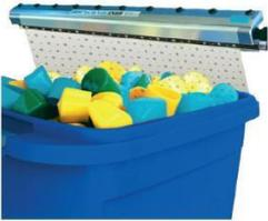
Unsere robusten **Ionisatoren** neutralisieren und reinigen bei einem Abstand von bis zu sechs Metern bei **geringem Druckluftverbrauch**. Der **ionisierende Luftvorhang** entfernt statische Aufladung von Plastikteilen, Textilien, Papierstapeln und anderen Produktoberflächen. Der **laminare Luftvorhang** reinigt mit ionisierter Druckluft Oberflächen von Partikeln, Staub und Schmutz.
