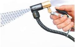
Die robuste und ergonomische **ionisierende Druckluftpistole** ist ein leichtes und effektives Gerät zur punktgenauen Reinigung. Die erzeugte **ionisierte Luft** baut statische Elektrizität in kürzester Zeit ab. Die ionisierende Druckluftpistole kombiniert unglaublich schnelle **Abbauraten statischer Elektrizität** mit niedrigem Druckluftverbrauch.
